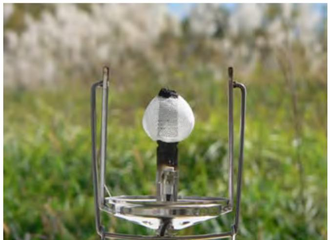
空焼き完了：全体が炭化し、白くなったら空焼きの完了です。マンツルが風などに壊されないように、空焼きが終了したら速やかにホヤ（グローブ）とベンチレーターを取り付けましょう。
