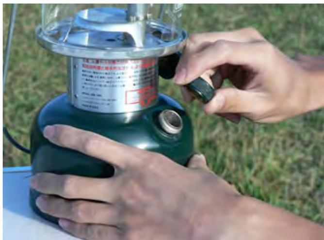
燃料キャップをあける：燃料のつまみをOFFになっているのを確認し、使用中であれば、火が完全に消えていることを確認します。確認後に燃料キャップをあけましょう。
