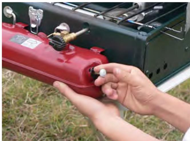
ポンピング3: ポンプノブの中央にある穴を押さえずに引きます。ポンピング2, 3を100回程度を目安に固くなるまで繰り返します。固になったら、ポンプノブを右にまわします。
