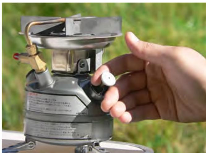
ポンピング3: ポンプノブの中央にある穴を押さえずに引きます。ポンピング2, 3を50回程度を目安に固くなるまで繰り返します。固になったら、ポンプノブを右にまわします。
