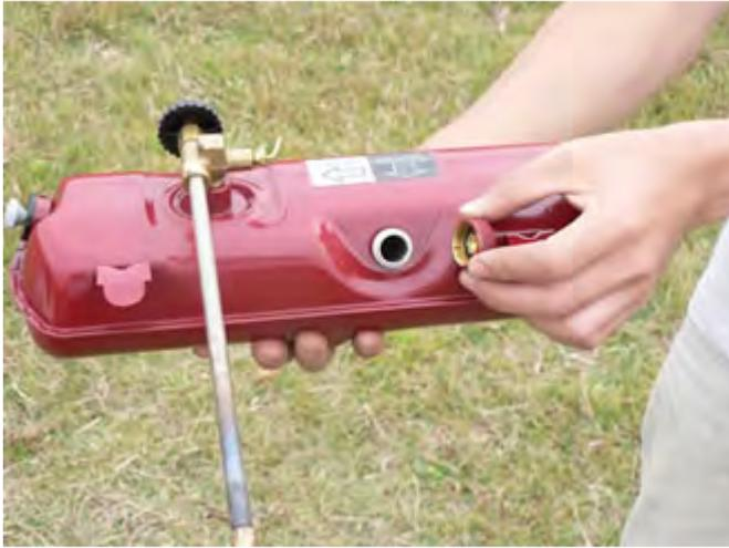
燃料キャップをあげる: 燃料タンクを本体から取り外し、燃料のつまみがOFFになっているのを確認します。使用中であれば、火が完全に消えていることを確認します。確認後に燃料キャップをあげるようにします。
