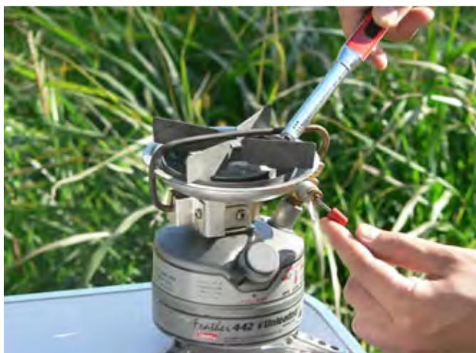
着火: 燃料のつまみをまわし、燃料が噴出する音を確認しながら着火する。着火後にさらにポンピングをし、炎を安定させます。
