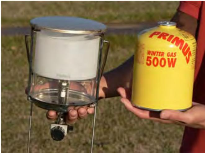
確認: 燃料のつまみがOFFになっていること、マンツルの破れがないかを確認します。
