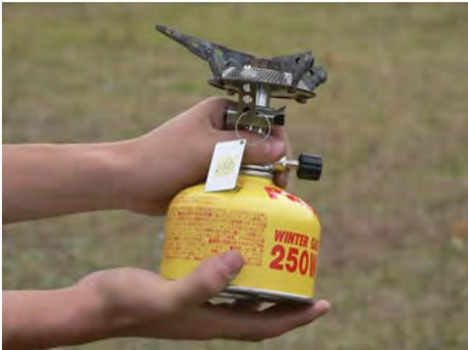
セット完了: ある程度固くなるまで回してセットの完了です。くれぐれも回しすぎに注意しましょう。バーナー本体とガスカートリッジは事故を防ぐためにも、必ず同一メーカーのものを使いましょう。
