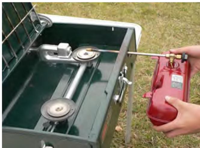
燃料タンクのセット: 燃料タンクを取り出し、タンクについているジェネレーターの先端をメインバーナーの上にある穴に差込み、燃料タンクのセット完了です。
