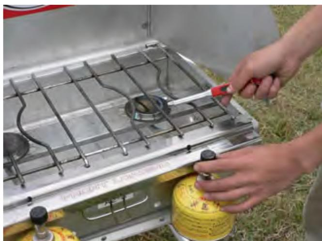
着火: 燃料のつまみを少しづつ回し、ガスが出る音を確認します。音が確認できたら、ライターなどで着火します。また最近のものは自動着火装置がついているものが増えてきました。自動着火装置もライター同様に、ガスが出る音を確認してから押しましょう。状況により自動着火装置は着火しない場合がありますので、2、3回連続で押ししてもつかない場合は燃料のつまみをOFFに戻します。滞留しているガスが無くなってから、同じ作業を繰り返して着火させましょう。
