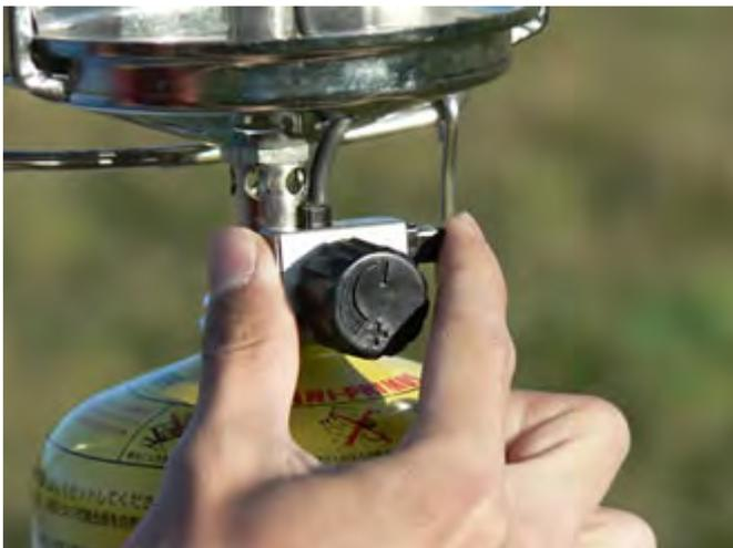
着火2: ガスが出る音を確認できたら、自動着火装置を押し火花をスパークさせて着火します。しかし、状況により着火しない場合があります。2, 3回連続で押してもつかない場合は、燃料のつまみをOFFに戻します。滞留しているガスが無くなってから、同じ作業を繰り返し着火させましょう。
