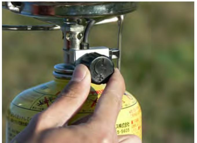
着火1: 燃料のつまみを少しづつ回し、ガスが出る音を確認します。
