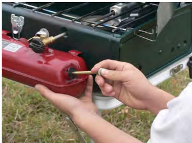
ポンピング2: ポンプノブの中央にある穴を押さえながら押し込みます。
