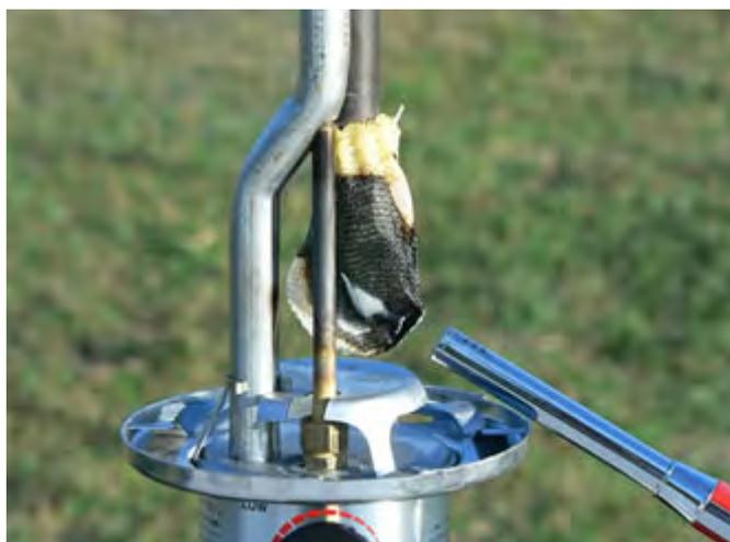
空焼き: 取り付けしたマンツルを空焼きする前にシワをとり形を整えます。それから、マンツルの下から火を付け、空焼きをします。
