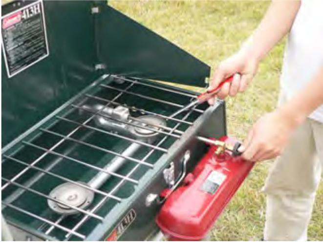
着火:まず点火レバーを上向きにセットします。それから燃料のつまみをまわし、燃料が噴出する音を確認しながら着火する。着火後にさらにポンピングをし、炎を安定させます。炎が安定したら点火レバーを下向きにします。
