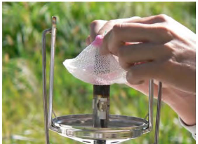
マンツル取り付け：ガスが出るチューブの部分にマンツルを取り付けます。
