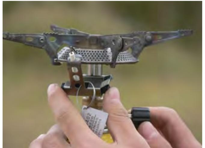
着火: 燃料のつまみを少しづつ回し、ガスが出る音を確認します。音が確認できたら、自動着火装置を押し火花をスパークさせて着火します。しかし、状況により着火しない場合があります。2, 3回連続で押ししてもつかない場合は、燃料のつまみをOFFに戻します。滞留しているガスが無くなってから、同じ作業を繰り返し着火させましょう。
